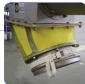
Bocca di scarico in materiale plastico ad alto rendimento
